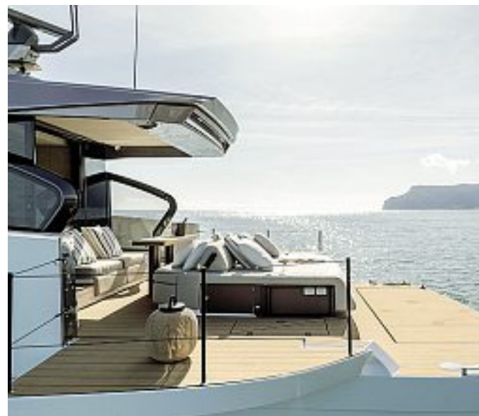
Seadeck 6 L'esterno con il sughero naturale ultra-leggero scelto per il deck
